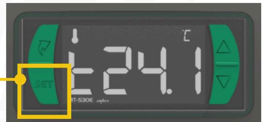
El indicador "SP1" controla la temperatura del equipo secadero, una vez posicionado en el mismo llevar la temperatura a la indicada en la receta por ej 24 grados
